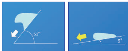
従来品は 51°の角度を付けてようやく水が流れますが…… 超疎水タイプは、わずか9°の角度で水が流れ落ちます。
